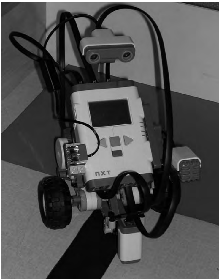
FIGURA 1 Il robot equipaggiato con tre sensori
